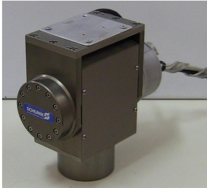
Figura 3.2: La muñeca usada en el movimiento de la cámara.
