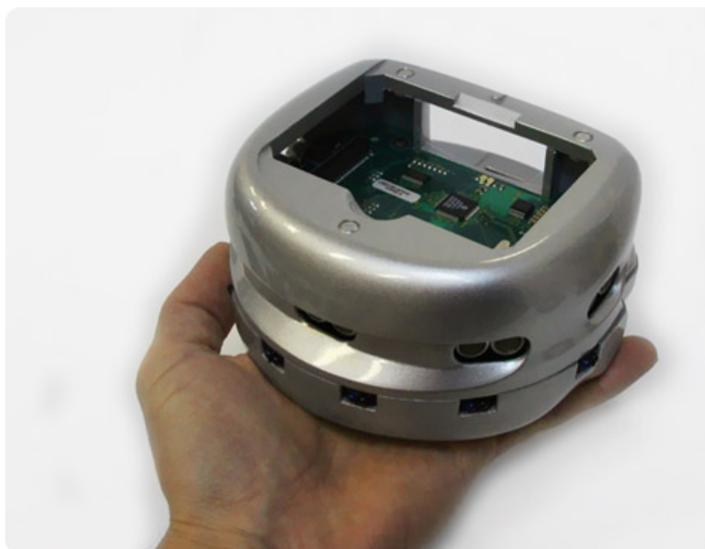
Figura 1.6: El robot Khepera con vista del interior.
