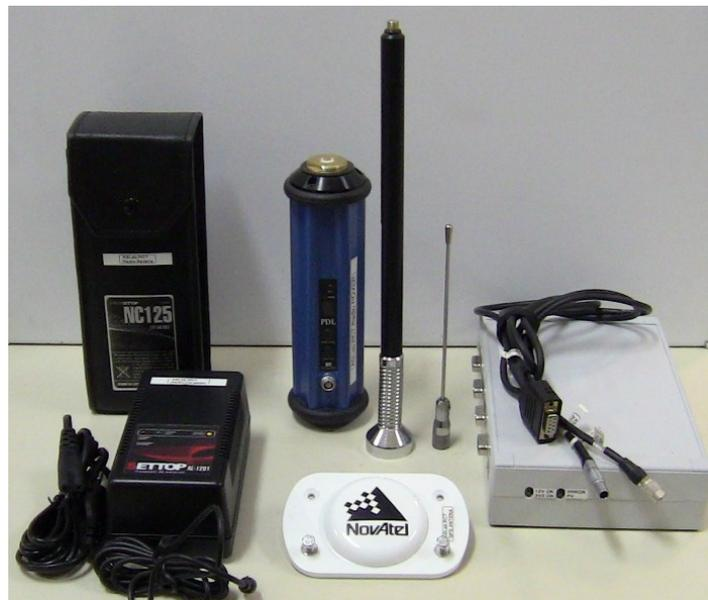
Figura 3.5: Componentes que forman el sistema GPS de la estación móvil
