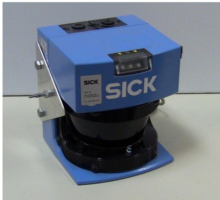
Figura 3.4: El sensor láser SICK LMS200
