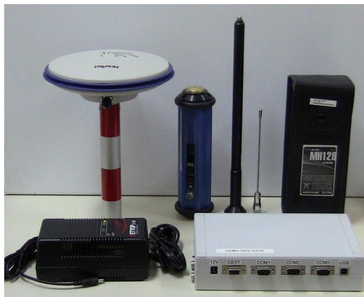
Figura 3.7: Componentes de la estación base del sistema GPS
