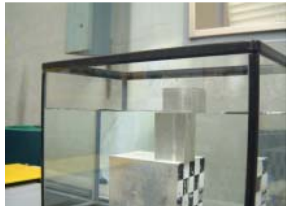
図1. 屈折による画像の歪み
